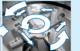
洗浄室内トルネード状態 矢印のようにエアが流れている。
